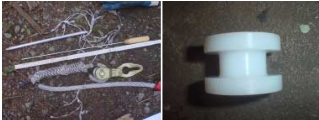
Abbildung 2: Eingespleißte Endrolle und Seilerwerkzeug (links), Kunststoffrolle Ø 32mm (rechts)
